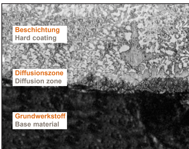
Bild 6 Übergang der gespritzten und eingeschmolzenen Schicht zum Grundwerkstoff (V=500:1) Figure 6 Cross-section of Arguloy coating, transition zone and base material
