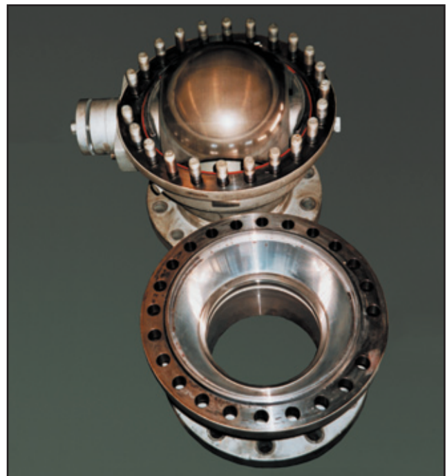
Bild 1 Argus Kugelhahn mit metallischem Dichtsystem nach 70.000 Schaltungen
